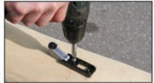
7. Befestigen Sie die einfache Umlenkrolle ③, sowie das Tauwerk mittels Seilklemme ① am Sonnensegel - siehe Skizze unten.
