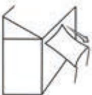
Es ist wichtig, das Sonnensegel mit einem Gefälle von mindestens 25%\* Neigung zu spannen, um den Wasserabfluss zu gewährleisten und die Bildung eines Wassersackes zu vermeiden.
