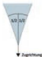
Um das Segel richtig spannen zu können und unschöne Falten, sowie durchhängen zu vermeiden, muss auch die Zugrichtung in der winkelhalbierenden eingehalten werden. Setzen Sie Befestigungspunkte immer in der Verlängerung der Segelecke.
